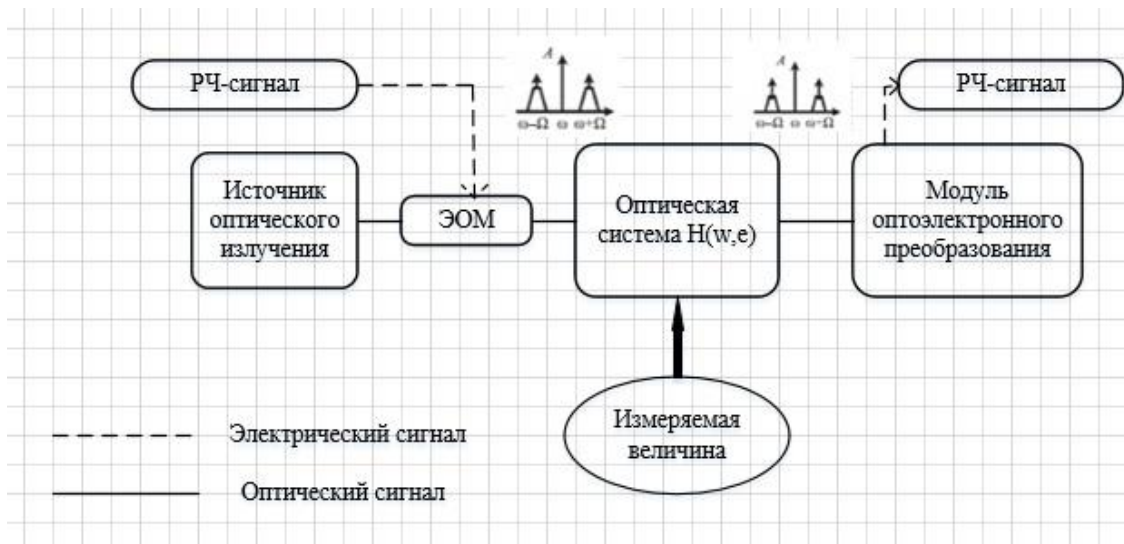
Рисунок 2 – Структурная схема радиофотонного волоконно–оптического измерительного прибора: A – амплитуда оптического сигнала; \omega – центральная частота оптического сигнала; \Omega – центральная частота РЧ-сигнала
