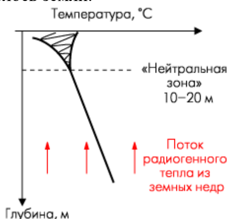
Рисунок 1. График изменения температуры грунта в зависимости от глубины.
