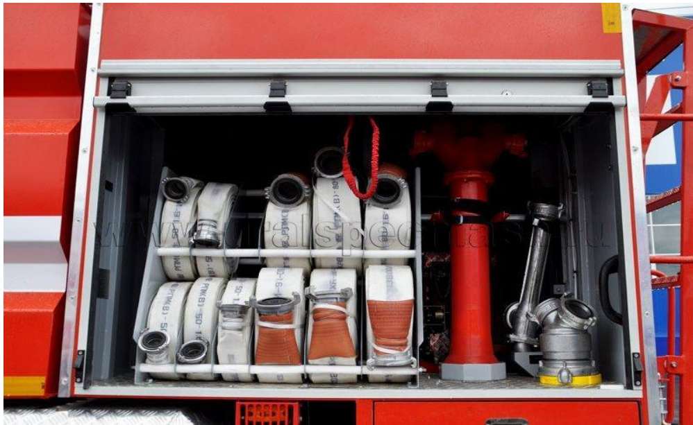
Рисунок. Напорные пожарные рукава в отсеке пожарной цистерны
