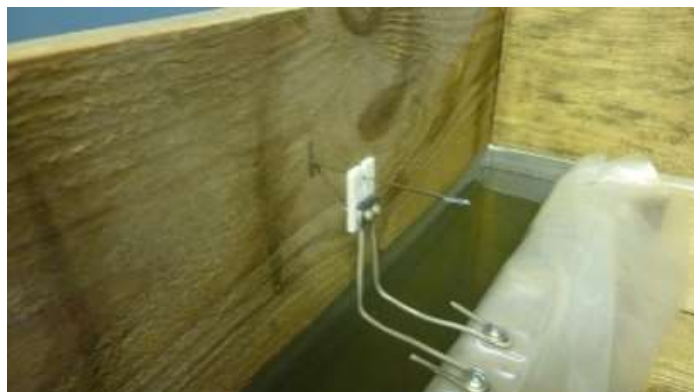
направляющие для поплавка (сталь-фторопласт)
