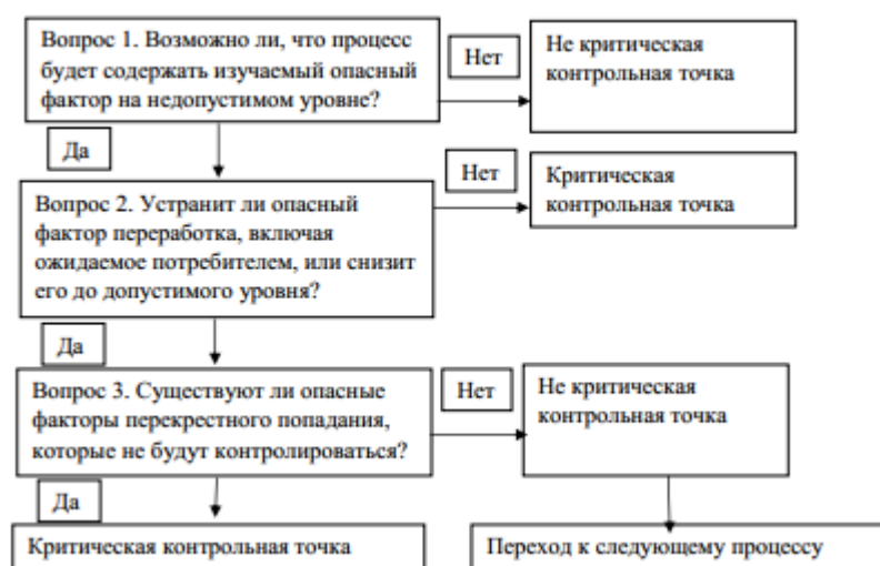
Рисунок 1 - Алгоритм принятия решений в отношении критических контрольных точек
